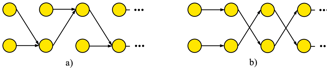
Figura 29. Ejemplos de distribución de los grados de entrada; a) Grafo donde P_{E0} = P_{E2} = 0.5 ; b) Grafo donde P_{E1} \approx 1 .
