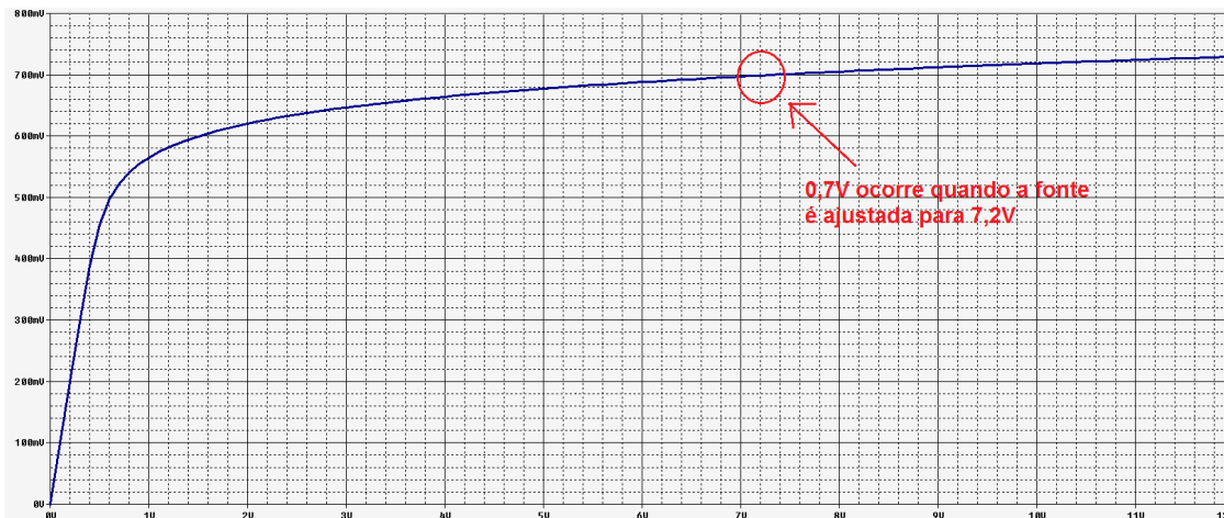
Fig. 27 – Queda de tensão sobre o diodo de silício x tensão da fonte.
