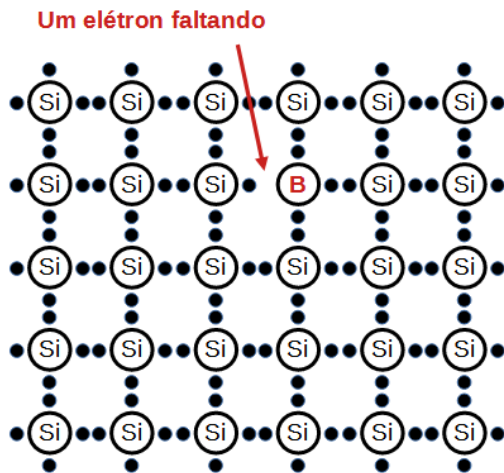
Fig.7 – Cristal de silício com um átomo de boro (Cristal P).
