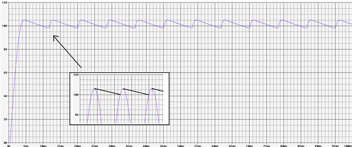
Fig. 52 – Efeito do capacitor no sinal de saída.
