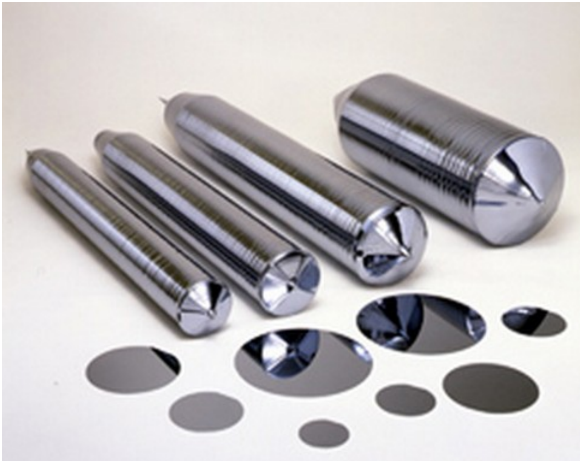
Fig.5 - Tarugo de cristal de silício e lâminas cortadas. [1]
