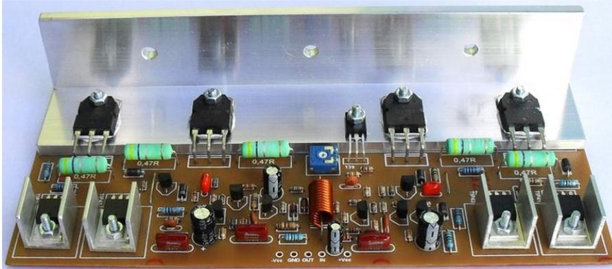
Fig. 4.1 Circuito amplificador de áudio.
