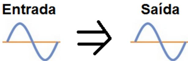
Esta configuração é utilizada como circuito intermediário (buffer), pois apresenta na entrada uma alta impedância e na saída uma baixa impedância. Veremos a importância disto quando estudarmos o efeito da carga nos amplificadores.
