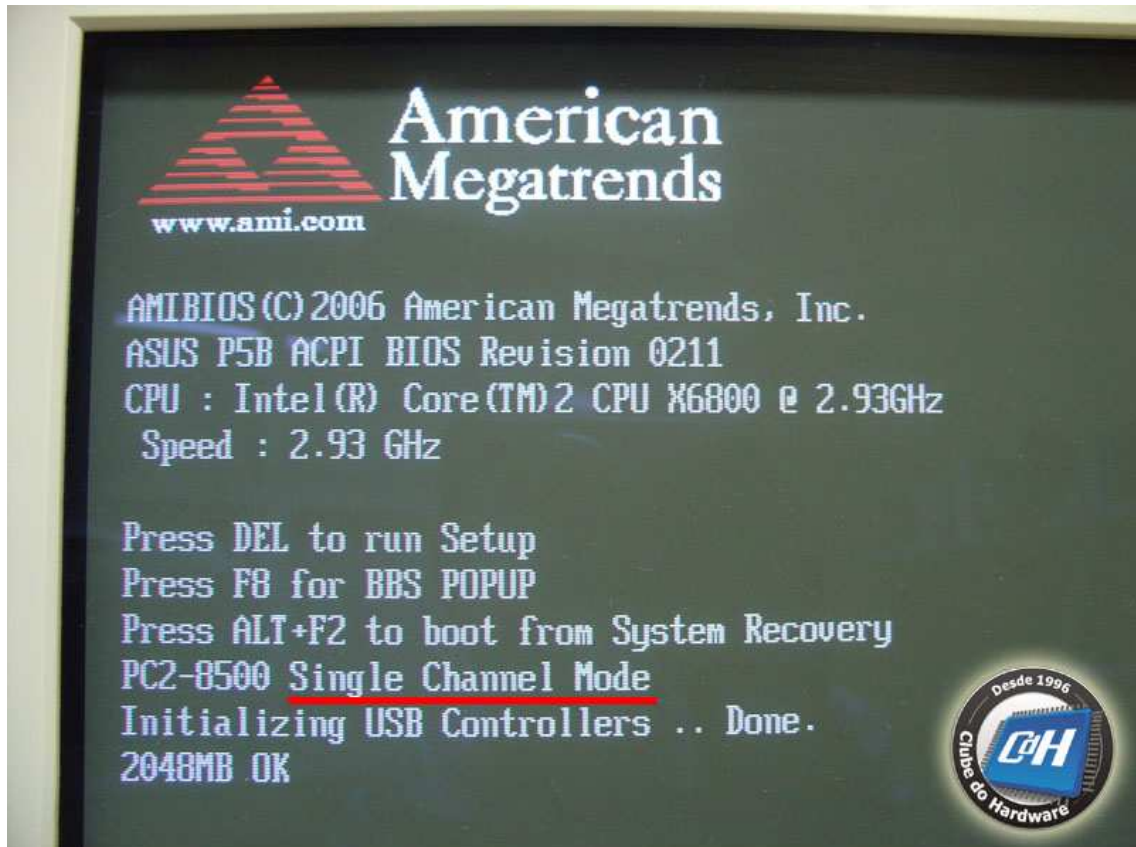
Figura 12: Nossa memória está configurada para trabalhar no modo de um único canal (o segundo módulo estava instalado no lugar errado).
