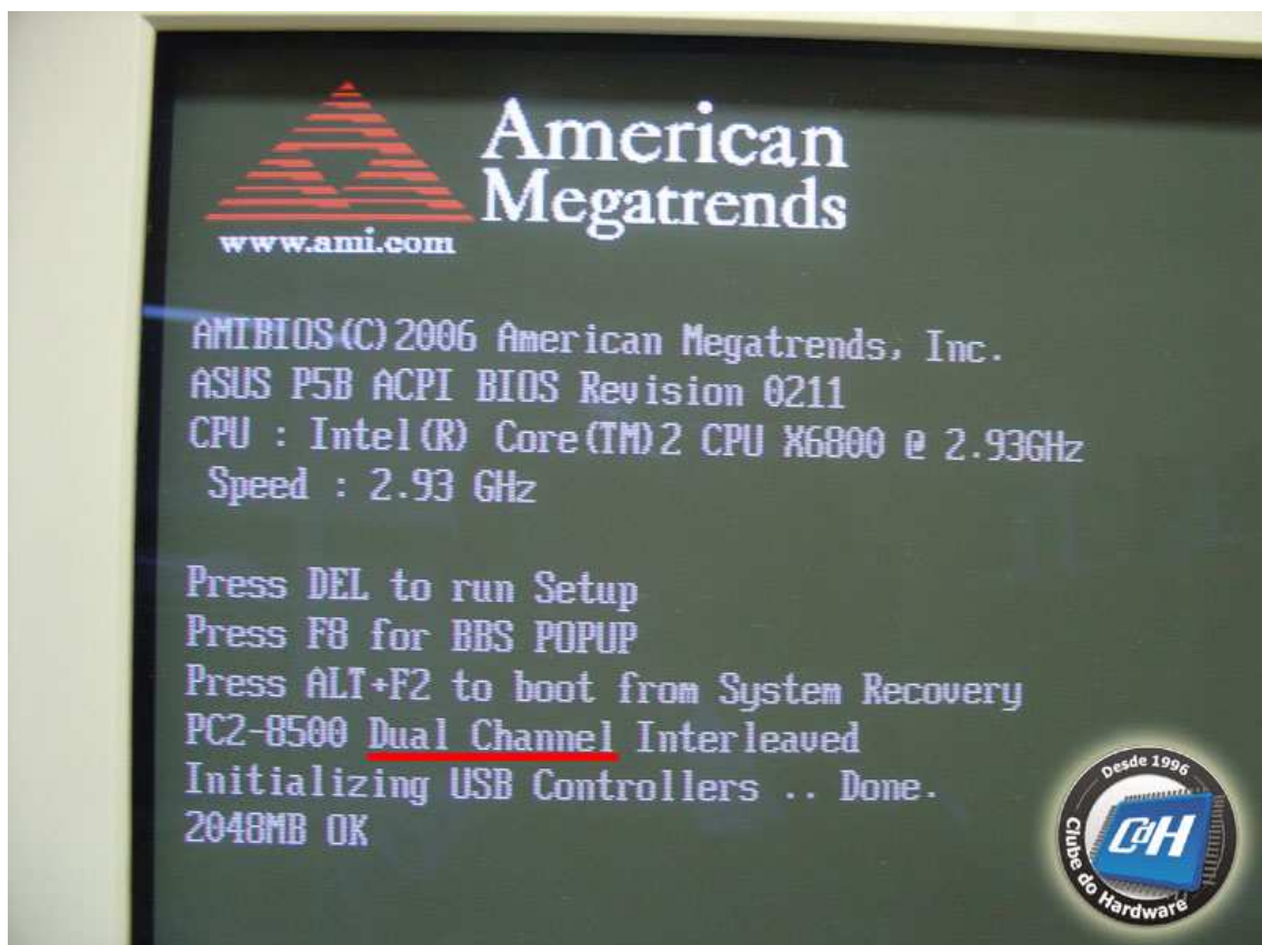
Figura 13: Nossa memória corretamente configurada para trabalhar no modo de dois canais.
