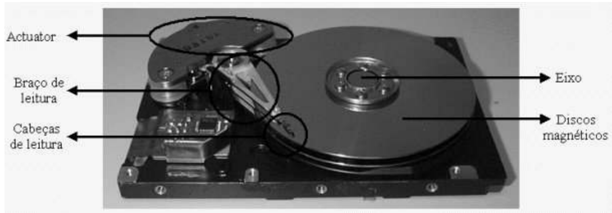
DESCRIÇÃO DOS COMPONENTES PRINCIPAIS DE UM HD
