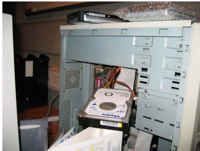
HD INSTALADO NO GABINETE
