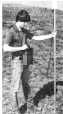
A causa de la extrema sensibilidad, para no afectar las lecturas los operarios deben despojarse de todos los objetos magnéticos como cuchillos, hebillas, gafas de armadura metálica o llaveros. Es típico que los magnetómetros geológicos se coloquen en pértigas de 2 a 3 metros de longitud con el fin de atenuar cualquier influencia proveniente del operador (ver figura).
