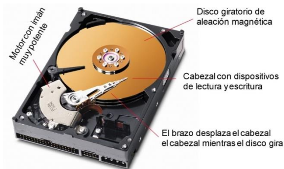
Figura 2.18 Disco duro (HDD). Pueden poseer 4 o más brazos móviles.
