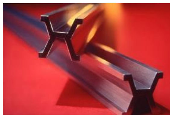
Figura 2.19. Patrones secundarios del metro patrón primario (distancia entre dos marcas en la superficie de la barra).
