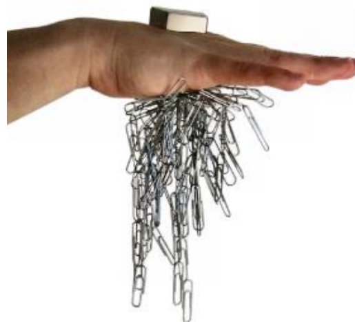
Figura 2.16 Efectos sorprendentes obtenidos con superimanes sintéticos contemporáneos de neodimio-hierro-boro. El imán colocado en la parte superior de la mano es capaz de atraer (y también magnetizar) las presillas en la parte inferior, que se atraen unas a otras a lo largo de las líneas de fuerza.
