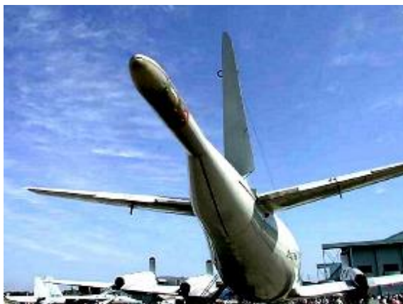
Figura 6.16 Botolón con el magnetómetro detector de anomalías magnéticas en su interior, en un avión P-3C Lockheed.
