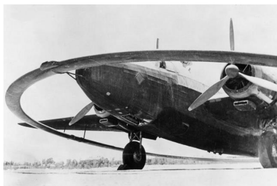
Figura 6.10 El avión AF Vickers Wellington DWI Mark II de la Royal Air Force fue otra respuesta para neutralizar las minas magnéticas alemanas. El anillo de madera de balsa, de 4 m de diámetro, creaba un campo magnético mediante una bobina de aluminio alimentada por un generador dentro del avión. Al volar rasante sobre el agua hacía estallar las minas.
