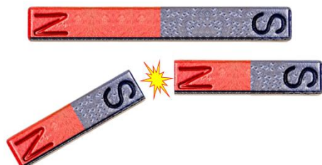
Figura 2.5 Dipolo magnético. Los polos magnéticos no se pueden separar. Al dividir la barra, cada segmento conserva sus dos polos.
