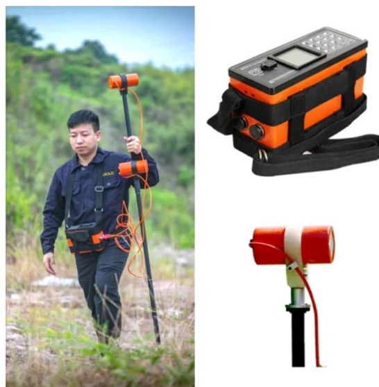
Figura 6.12 Prospección de minerales ferrosos. El magnetómetro se encuentra en el extremo de la pértiga.
