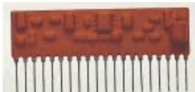
Figura 1: Circuito híbrido de capa gruesa, encapsulado para una aplicación de instrumentación electrónica.
