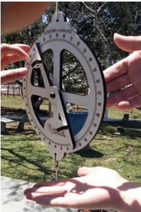
Figura 1: Medición de la altura solar con el Astrolabio Marino.
