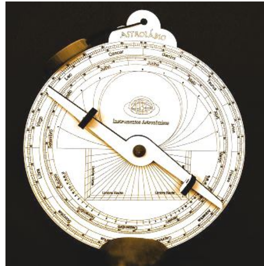
Figura 2: Astrolabio Planisférico. Izquierda: Representación de la bóveda celeste. Derecha: Alidada y herramientas de cálculo
