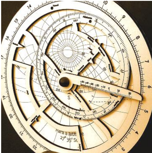
Figura 2: Astrolabio Planisférico. Izquierda: Representación de la bóveda celeste. Derecha: Alidada y herramientas de cálculo
