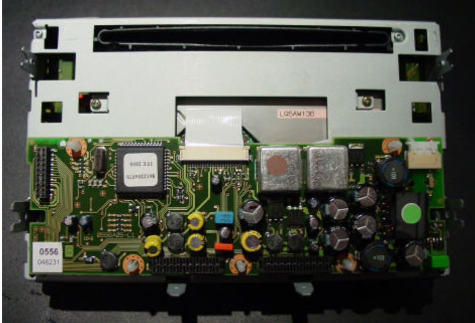
Dann an den Beiden Unteren Pins ein Kabel anlöten:
