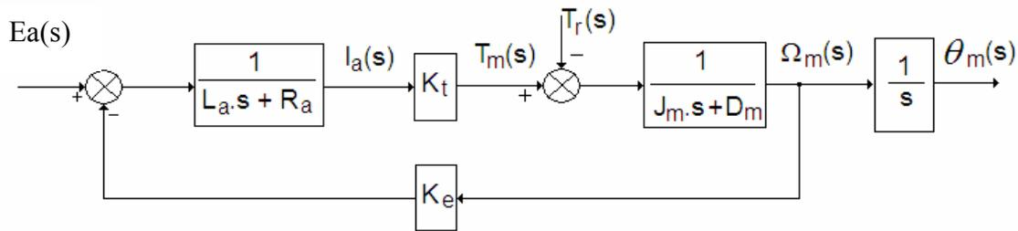
Considerando que não há variação no torque resistente (Tr), a função de transferência do motor é dada por:
