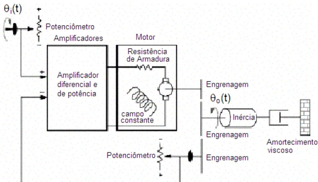
Convertendo o sistema elétrico acima em diagrama de blocos, obtemos:
