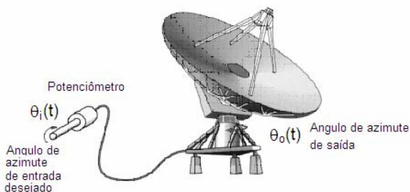
O objetivo é posicionar a antena através do ângulo de entrada do potenciômetro obtendo um sistema estável, maximizando o desempenho do sistema e minimizando o erro. É claro que o sistema acima está simplificado, pois há a necessidade de inserir o motor e o redutor que irão movimentar a antena, o controlador do processo e o sensor de realimentação. A figura seguinte mostra o esquema mais detalhado:
