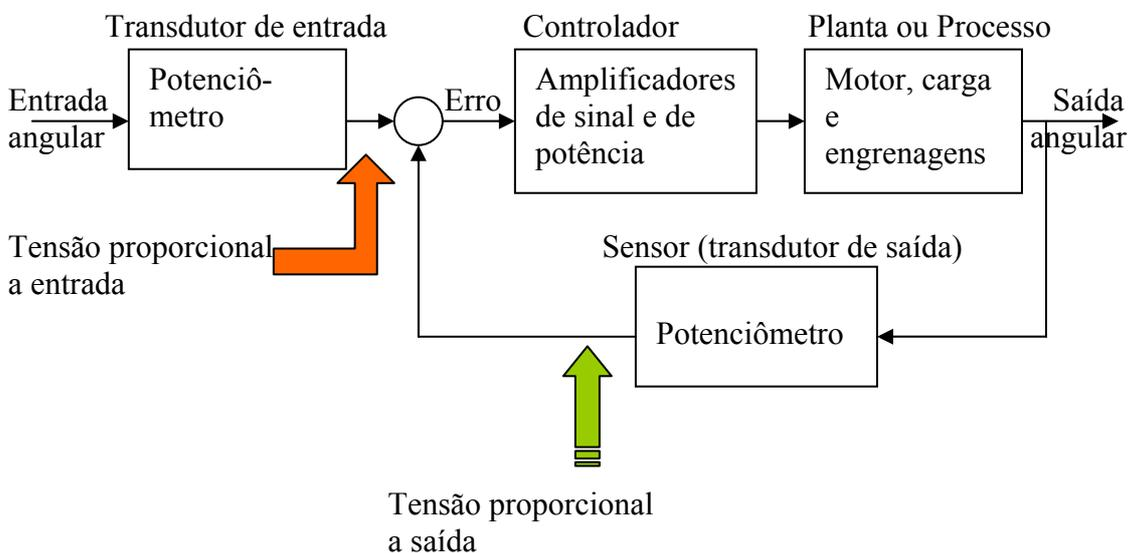
*1º Passo:* Com o objetivo definido (minimizar erro estacionário, maximizar desempenho) e com um diagrama de bloco inicial, o primeiro passo será obter as funções de transferências de cada bloco. Para isso deve ser usado o modelamento do sistema (módulo 2) e transformada de Laplace (módulo 3).
