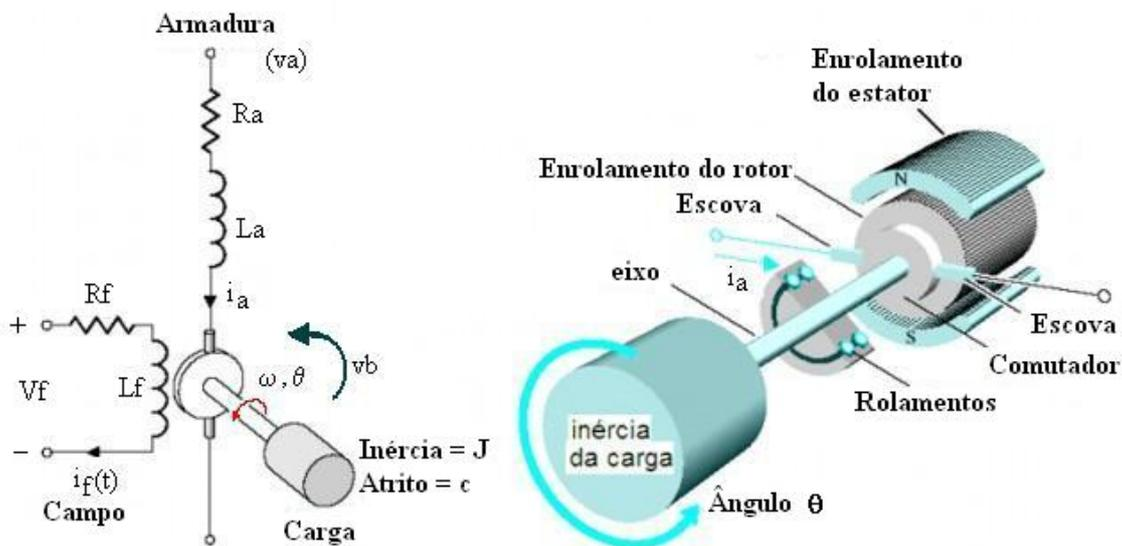
O diagrama acima mostra que o motor é composto de dois circuitos: circuito de campo e circuito de armadura. Esses circuitos são ligados através do fluxo magnético e da tensão induzida.
