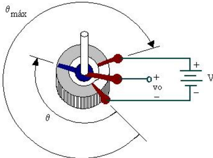
A entrada de um potenciômetro é a posição (ou rotação) do knob (mecânico) e sua saída é a diferença de potencial  $v_o$  (elétrico).
