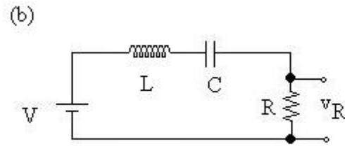
Exercício 4: Determine a relação entre a saída de tensão no capacitor e a entrada de tensão  $v$  do circuito abaixo:
