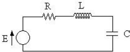
O circuito ao lado possui apenas uma malha. Para fazer a análise de malha é conveniente supor a existência de correntes percorrendo a malha.
