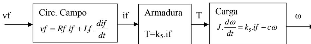
Motor controlado pela armadura:
