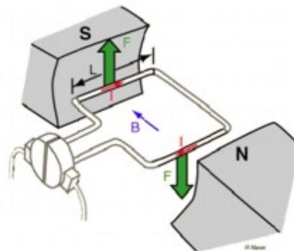
Quando um condutor (bobina) de comprimento  $L$ , circulando uma corrente elétrica  $i_a$ , passa através de um campo magnético  $B$  aparece um força  $F$  sobre o condutor:
