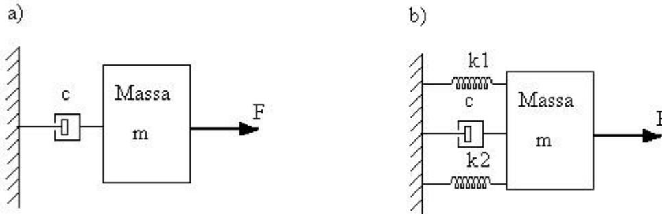
Exercício 2) A figura seguinte mostra um modelo mecânico para suspensão de um automóvel. Forneça o modelo matemático do sistema:
