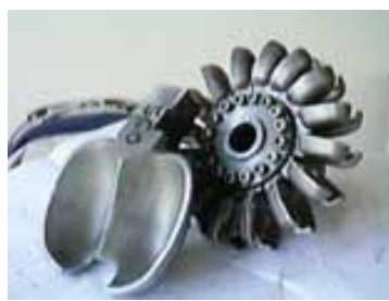
Pelton - máquinas de ação, altas quedas e baixas vazões
