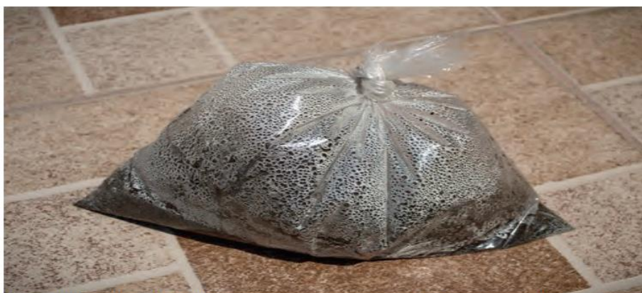
Figura 1.38 Si se deja al sol, el lodo permanece más tiempo húmedo dentro de una bolsa que fuera de ella, esto es evidente debido a las gotitas de agua que se forman dentro del plástico.
