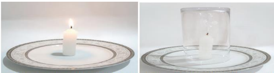
Figura 2.18 a) La combustión de la vela sucede a rapidez constante porque la concentración del oxígeno en el ambiente es alta y no se ve afectada por el proceso, pero b) al cubrirla con un vaso, las condiciones cambian.
