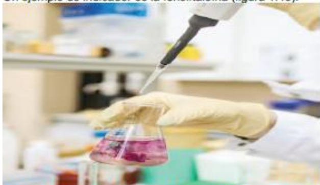
Figura 1.45 Al agregar una disolución de fenolftaleína a una disolución de una base, la primera se transforma en otra sustancia de color rosa, lo que confirma la presencia de la base.
