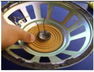
VAMOS COLAR O CENTRALIZADOR NA CARCAÇA DO FALANTE VIRE OS FIOS DA BOBINA EM DIREÇÃO AOS TERMINAIS DO FALANTE,PASSE O ADESIVO PARA JUNTA DE MOTORES,EM QUANTIDADE MAS SEM EXAGEROS.(VEJA FOTO)
