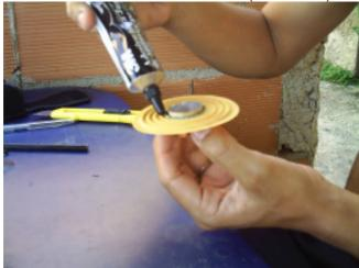
COM A BOBINA COLADA NA CENTRAGEM,ENCAIXE E VEJA SE ESTÁ TUDO EM ORDEM,COM A PONTA DOS DEDOS,FAÇA LEVE PRESSÃO PARA BAIXO,PARA VER SE A BOBINA NÃO ENCOSTA NA PAREDE DO IMÃ(VEJA FOTO)
