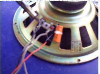
SE PRECISO,NESSA MESMA POSIÇÃO,ANTES DE FAZER A SOLDA DAS CORDOALHAS.COM O FERRO DE SOLDA BEM QUENTE,RETIRE O RESTO DA CORDOALHA VELHA QUE AINDA ESTÁ SOLDADA NO TERMINAL,FICARÁ UM FURO,ONDE VOCÊ IRÁ PASSAR A CORDOALHA NOVA,SOLDÁ-LA E CORTAR COM A TESOURA A SOBRA.
