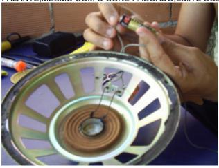
UTILIZANDO UMA PILHA, PRENDA A PONTA DE UM DOS FIOS DO FALANTE NA MESMA, COMO MOSTRA A FOTO.E COM A PONTA DO OUTRO FIO, FAÇA MOVIMENTO DE ATRITO, NO OUTRO TERMINAL DA PILHA, COMO SE TIVESSE LIXANDO.SE A BOBINA AINDA ESTIVER BOA, O FALANTE EMITIRÁ UM RUIDO
