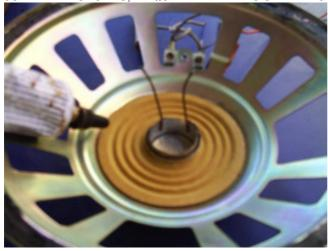
PRONTO. AGORA É SÓ COLOCAR O CONE E SOLDAR AS CORDOALHAS(VEJA EM SUBSTITUINDO UM CONE RASGADO)
