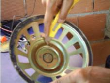
LIMPEZA FEITA, PARTIREMOS AGORA PARA A COLOCAÇÃO DA NOVA BOBINA E SEU CENTRALIZADOR.
