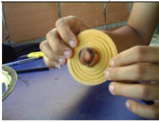
FAZENDO USO DA TIRA DE FILME DE RAIO X,VEJA SE A BOBINA SE ENCAIXA PERFEITAMENTE,SEM FICAR ENCOSTANDO NA PAREDE DO IMÃ (VEJA FOTO)
