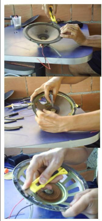
UTILIZANDO O ESTILETE,OU UMA CHAVE DE FENDA,RETIRE AS MOLDURAS DO CONE,COMO MOSTRA A FIGURA 1 ,COM CUIDADO VOCÊ AINDA APROVEITA ESSAS MOLDURAS.
