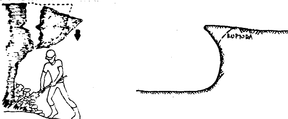
Figura 5- Despreendimento da crista do talude (fonte: Rousselet e Carson).
