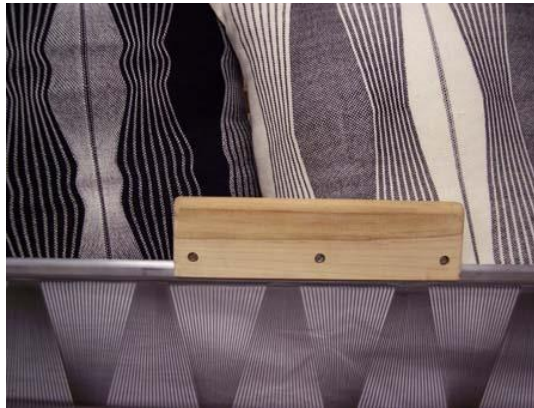
Rajah 5 : Gambarajah menunjukkan contoh tenunan menggunakan Fan Reed pada pemukul benang pakan
