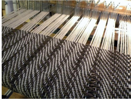
Rajah 7 : Gambarajah menunjukkan contoh RailReed yang telah di pasangkan pada pemukul benang pakan.
