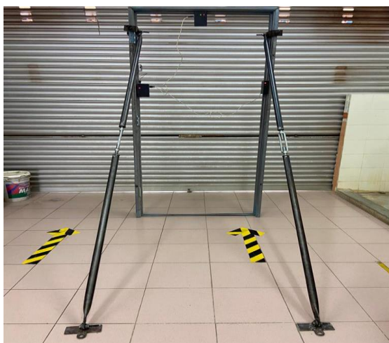
Rajah 1: Alat MFA yang telah dipasang pada kerangka pintu.
