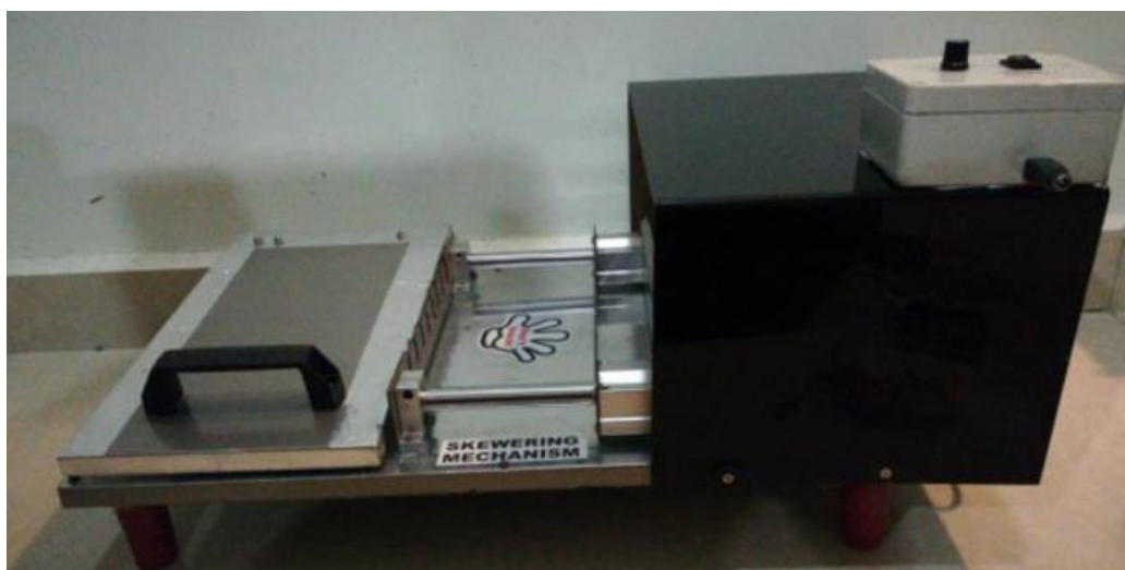
Rajah 3: Reka bentuk baharu Mesin Pencucuk Sate Semi Auto 2.0 yang telah siap
