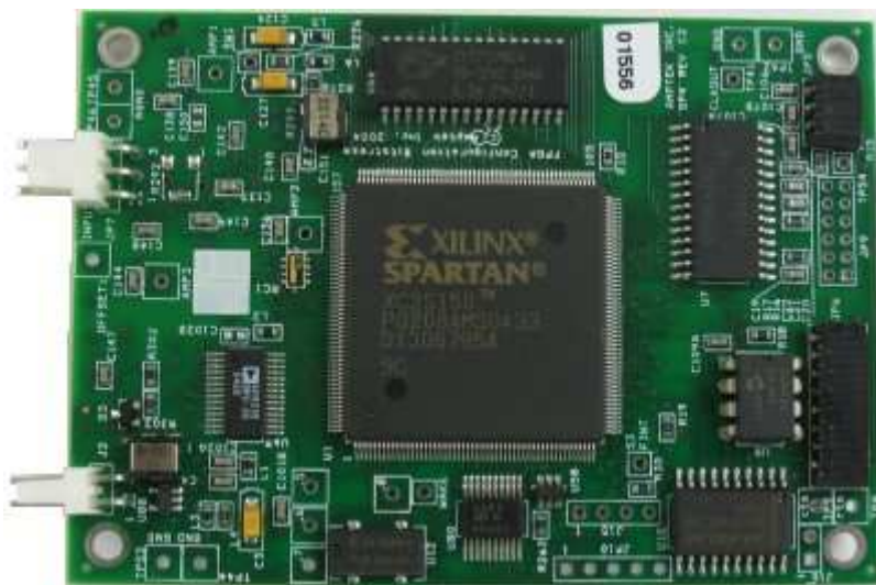
Figure 1.5 : Le processeur numérique de signal DP4 de Amptek
