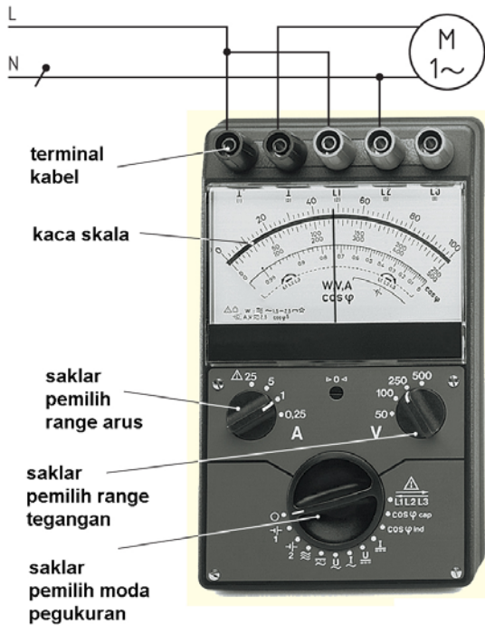
Gambar 8.18 : Pengawatan wattmeter dengan beban satu fasa
