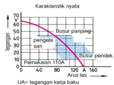
Gambar 4.27 : Grafik tegangan fungsi arus, pada Trafo Welding
