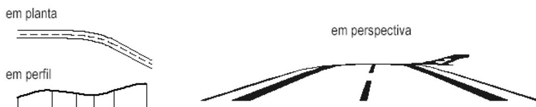
FIGURA D.14 – Defeitos em traçados: mergulho raso (Fonte: DER/SC DCE-C, 1999).
