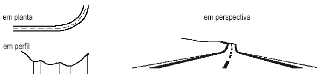
FIGURA D.13 – Defeitos em traçados: ondulações na curva (Fonte: DER/SC DCE-C, 1999).
