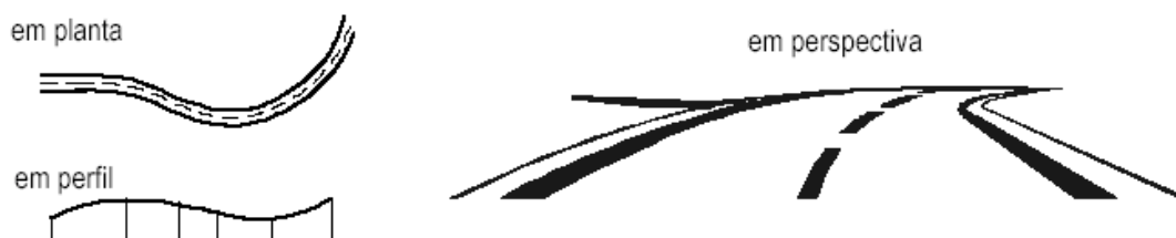
FIGURA D.16 – Defeitos em traçados: salto (Fonte: DER/SC DCE-C, 1999).
