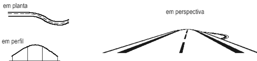
FIGURA D.18 – Defeitos em traçados: início da curva horizontal na área convexa (Fonte: DER/SC DCE-C, 1999).
