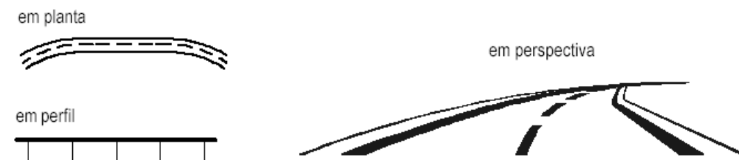
FIGURA D.08– Pista com dobra ótica (Fonte: DER/SC DCE-T, 1993).
