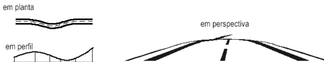
FIGURA D.17 – Defeitos em traçados: salto com deflexão (Fonte: DER/SC DCE-C, 1999).
